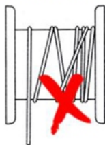
Рисунок 7. Правильность намотки грузоподъемного каната.
